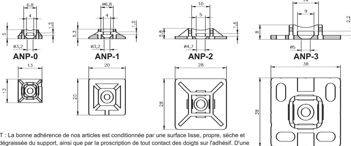
\* IMPORTANT : La bonne adhérence de nos articles est conditionnée par une surface lisse, propre, sèche et parfaitement dégraissée du support, ainsi que par la proscription de tout contact des doigts sur l'adhésif. D'une manière générale, nous préconisons des essais préalables.
