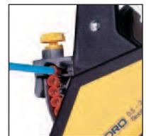
5. Sertir en avançant l'embout en butée avec le câble et serrer.
