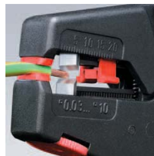
Dénudage précis sans endommagement du conducteur
