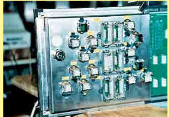
Han DD® und Han® Q 5/0 PCB-Adapter eingesetzt bei Wilhelm Fette GmbH, Deutschland
