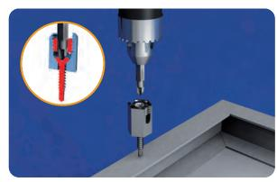
A l'aide d'une visseuse équipée d'un embout cruciforme PZ2, solfil se fixe rapidement en perçant et taraudant le châssis. Grâce à sa conception spécifique, cette opération se fait sans démontage de la vis de serrage du câble.
