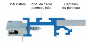
La fonction antirotation lors du vissage est assurée par les méplats sur le corps du Solfil
