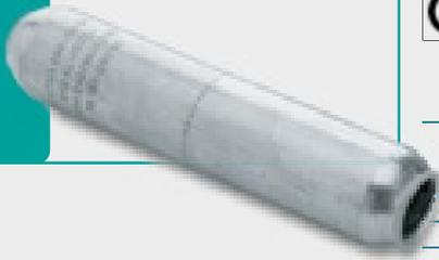
Les manchons de la série MTMA-GC sont réalisés à partir d'un barreau en aluminium d'une pureté égale ou supérieure à 99,5%. Les deux alésages sont non communicants. Une graisse est déposée à l'intérieur, afin d'éviter les éventuelles oxydations de l'aluminium. Un mastic est fourni pour combler l'empreinte des poinçons, dans le cas d'une "post-isolation" du manchon, afin d'éliminer toute poche d'air sous l'isolant.
