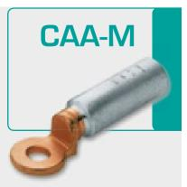
Le fût des cosses de la série CAA-M, est réalisé à partir d'un barreau en aluminium d'une pureté égale ou supérieure à 99,5%. L'assemblage des deux métaux est effectué par friction.
