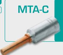
Le fût des cosses de la série MTA-C, est réalisé à partir d'un barreau en aluminium d'une pureté égale ou supérieure à 99,5%. L'assemblage des deux métaux est effectué par friction. Une graisse est déposée à l'intérieur du fût, afin d'eviter les éventuelles oxydations de l'aluminium. Un mastic est fourni pour combler l'empreinte des poinçons, dans le cas d'une "post-isolation" de la cosse, afin d'éliminer toute poche d'air sous l'isolant. Ces cosses sont utilisées en basse et moyenne tension.
