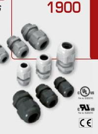
Matière: POLYAMIDE PA6.6 autoextinguible classifié V2 (UL 94) Température d'utilisation: de -20°C à +90°C (continue) Garniture: NEOPRENE® Étanchéité: IP 68 Couleur:
