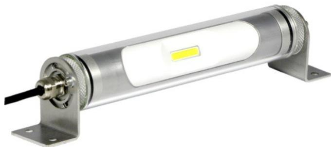
Système d'éclairage tubulaire, modulaire à technologie LED. Structure en aluminium recouvert de verre borosilicaté 3mm. Puissance 6-12-18-24W. Alimentation: 24Vdc.
