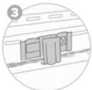
Insertion de la câblette cuivre et verrouillage en butée
