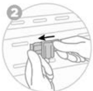
Faire glisser latéralement vers la gauche jusqu'au verrouillage en butée
